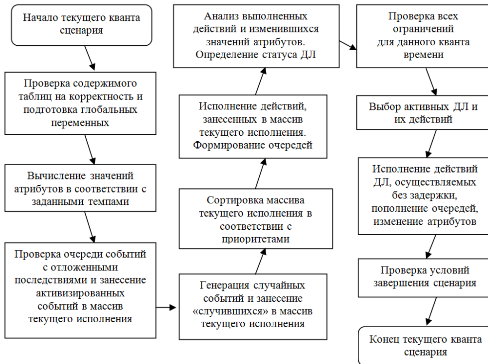
Рисунок 10. Упрощенная схема функционирования генератора сценариев
