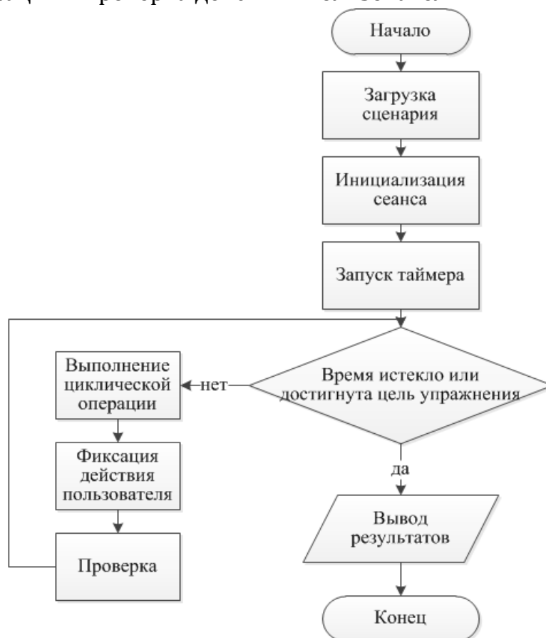
Рис. 2. Основной алгоритм подсистемы диагностики и контроля
