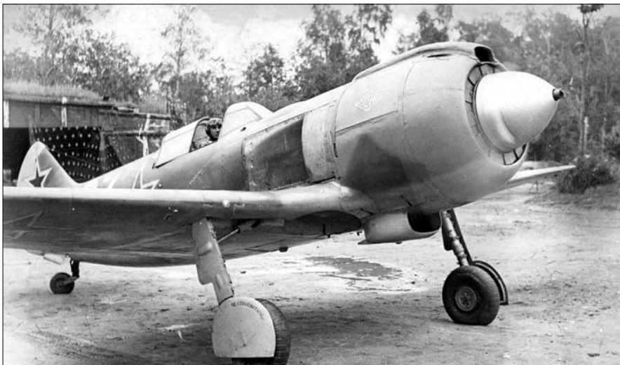
Советский боевой самолёт истребитель ЛА-5, год выпуска 1942, одноместный, одномоторный, максимальная скорость 648 км/час, дальность полёта 765 км, вооружён двумя пушками 20-мм.
