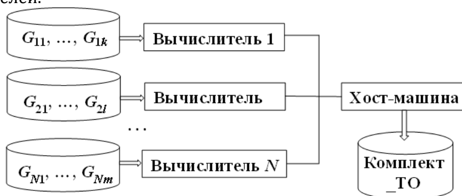
Рис. 2. SIMD-вычислительный комплекс для решения задачи снабжения и комплектации сервисных центров
