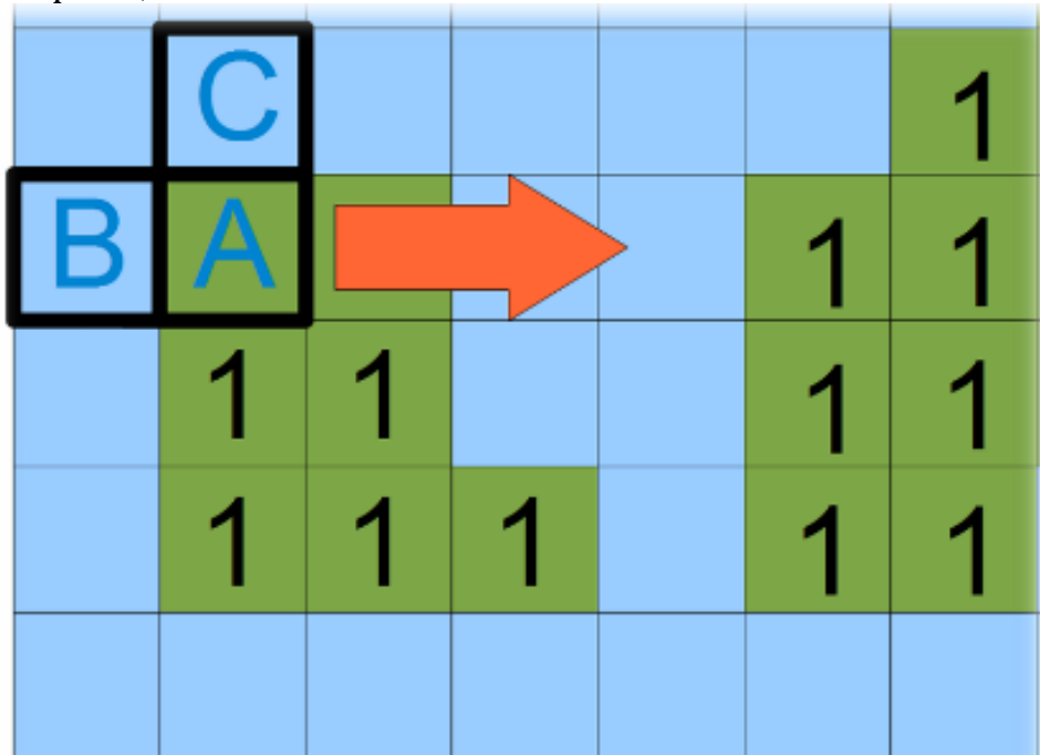
Рис.2. ABC маска и направление последовательного сканирования изображения
