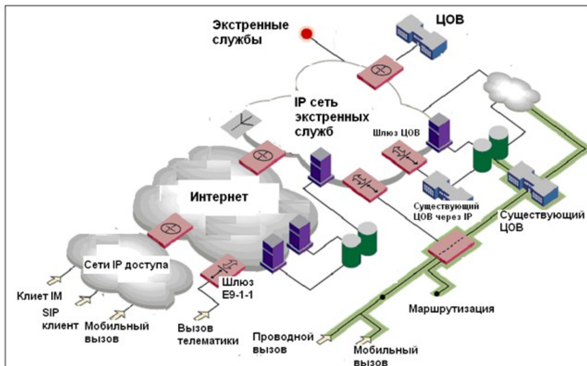
Рис. 3. Новое поколение экстренной службы NG9-1-1 и ее стыковка с существующей службой 911
