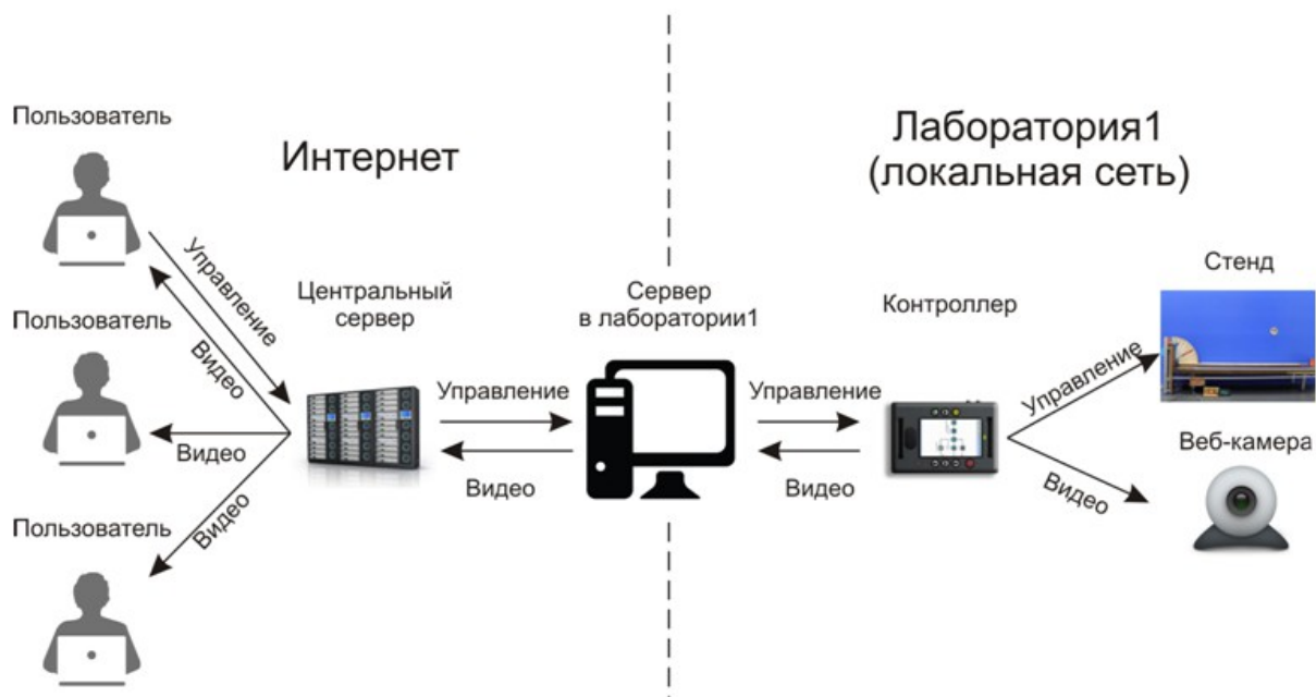
Рис.2. Общая схема работы удаленной лаборатории
