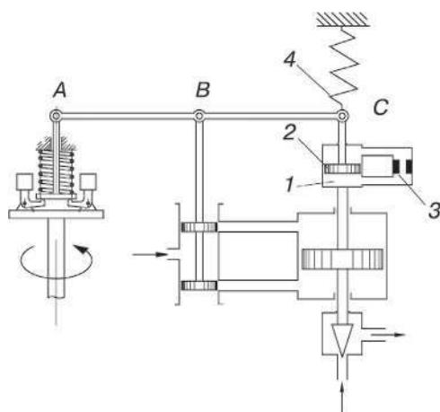
Схема изодромного регулятора
