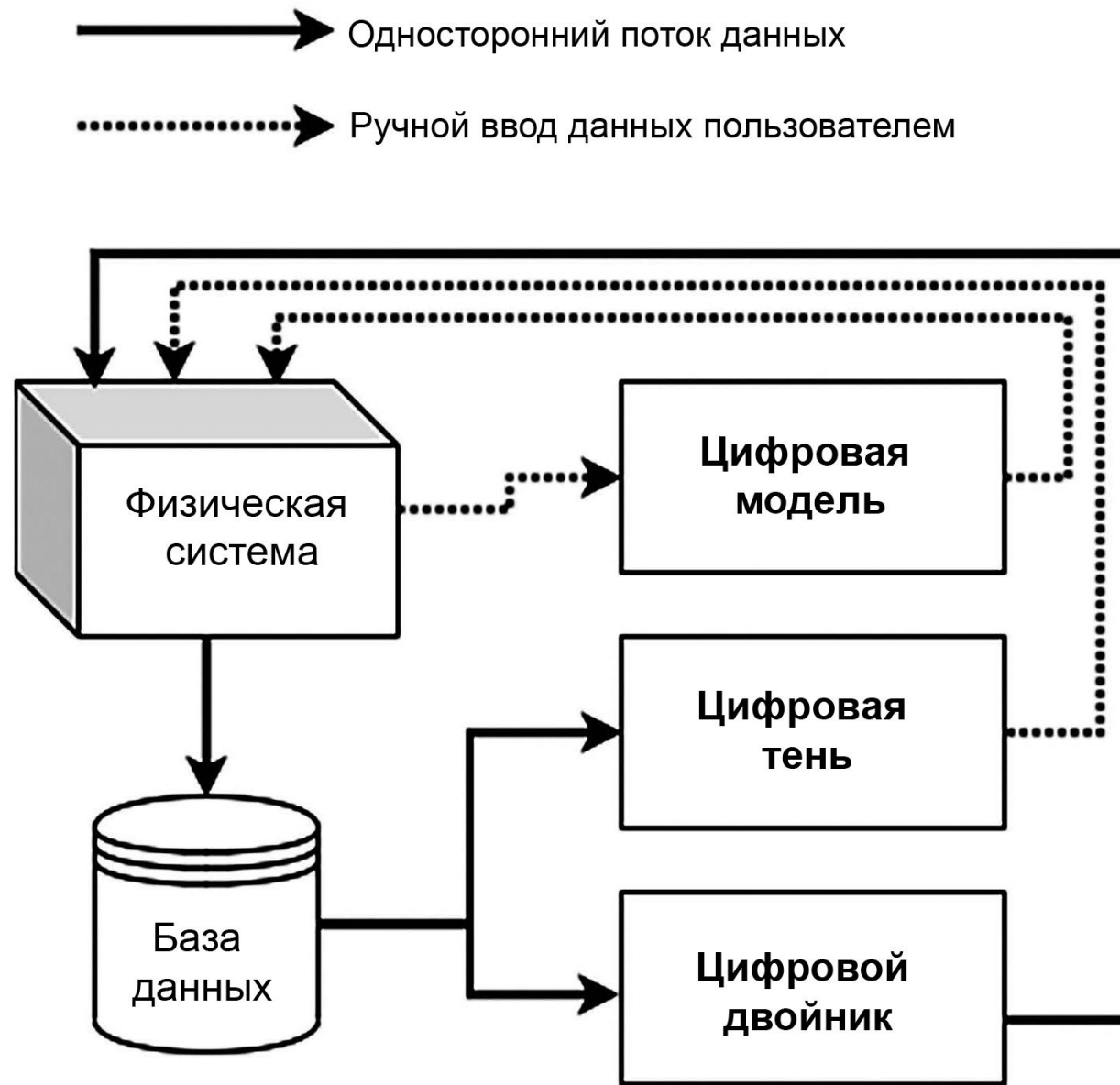
Рисунок 9.1. Поток данных от физической системы к виртуальной модели для цифровых двойников разных типов [34]
