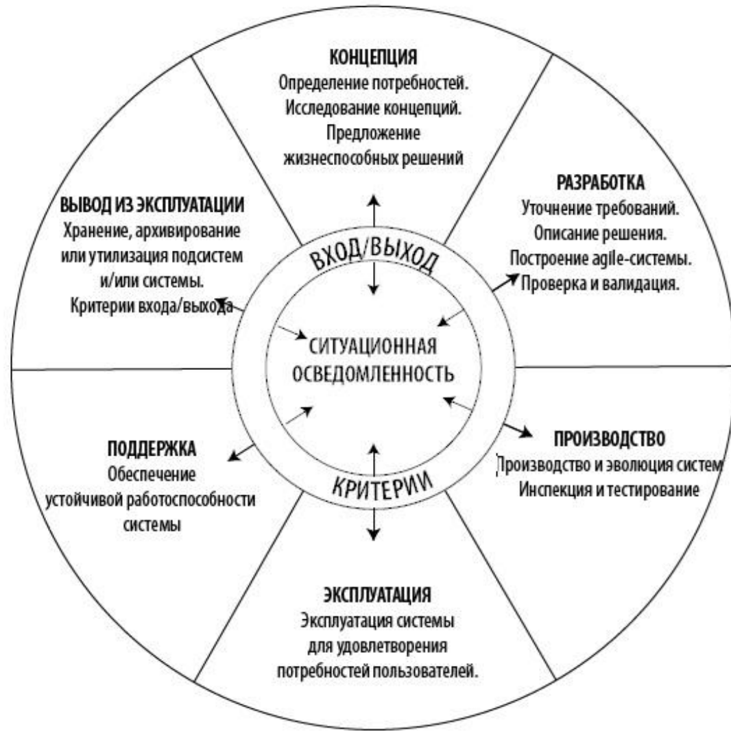
рис. 11. Цели для каждой стадии модели жизненного цикла, адаптированные из (ISO/IEC/IEEE 2018, стр. 17), с добавлением стадии «ситуационной осведомленности» - [7]
