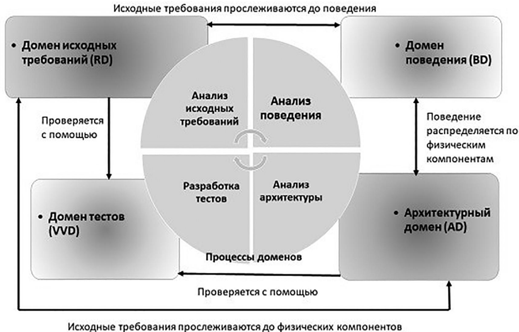
Рисунок 7.9. Структура основных доменов системной инженерии и соответствующих артефактов, определяющих структуру архитектурной и функциональной модели системы
