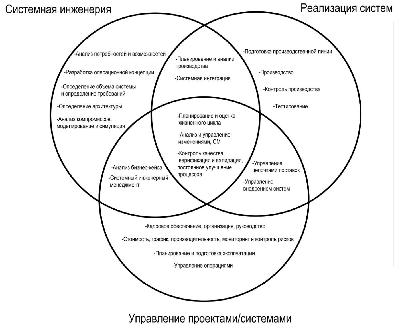
Рисунок 1. Взаимосвязь трех дисциплин - Системной инженерии , реализации систем (system implementation), и Управления проектами/системами (project/systems management):
