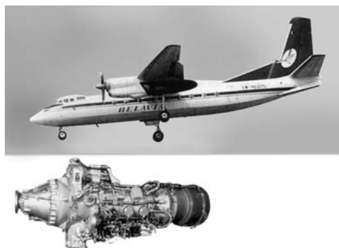
2. Самолет местных линий Ан-24 с двигателями АИ-24 и агрегатами НД-24 и АДТ-24
