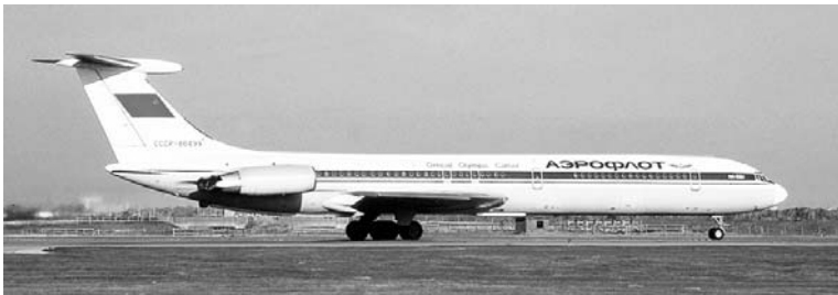
Лайнер Ил-62 с двигателями НК-8 и агрегатами АДТ-8А, НД-8, ОГ-8, РТ-8
