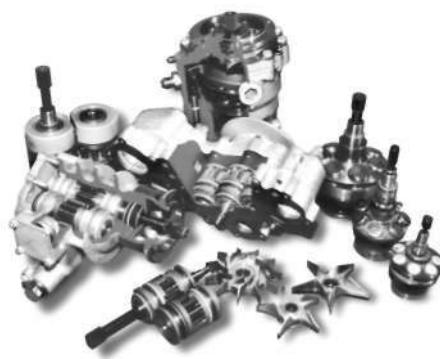
Элементы плунжерных, шестеренных и центробежных качающих узлов
