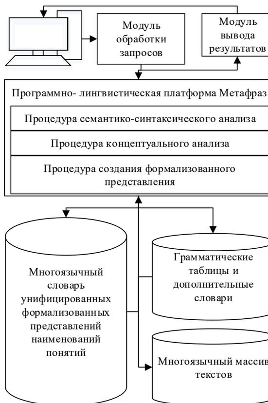
**Рисунок 3** Общая схема работы программного модуля поиска текстовой информации в многоязычных массивах
