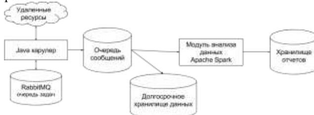
**Рисунок 3** Схема реализации системы с онлайн обработкой данных
