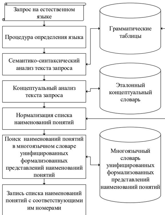
**Рисунок 2** Схема работы алгоритма трансформации поискового запроса в его унифицированное семантическое представление
