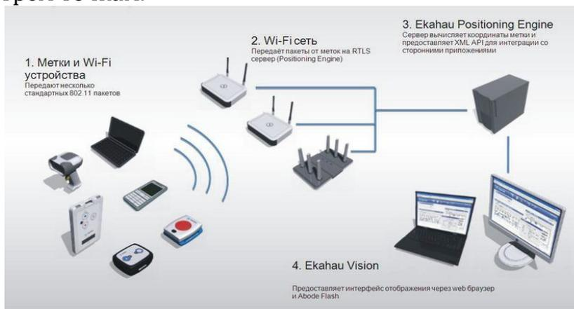
**Рис.2. Система позиционирования в помещении фирмы EkaHau**
